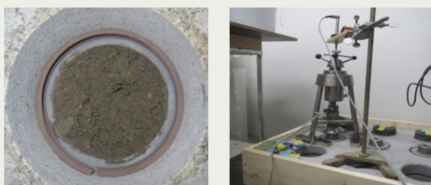
Nyutvecklad metod för provning av vidhäftningshållfasthet hos nysprutad betong.
