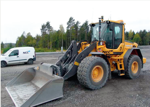
Figur 2a: Maskinguidad Hjullastare. Hjullastaren var utrustad med sensor-system och GNSS mottagare samt maskindator. Maskinen arbetade under tiden på flera olika arbetsplatser vilket gjorde att modelldatahaneringen var omfattande och ofta ändrades.
