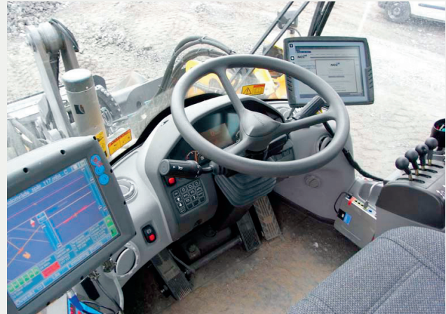
Figur 2b: Förarmiljön. För föraren så var hanteringen av data och modeller väsentlig. Maskindatorn GeoRog (till vänster) var uppkopplad med 3G-routen (till höger vid golvet) och modelldata skickades direkt från kontoret till maskinen. Han hade även en separat dator uppkopplad mot samma router där han tog emot e-post med ritningar och beskrivningar för de olika projekten.
