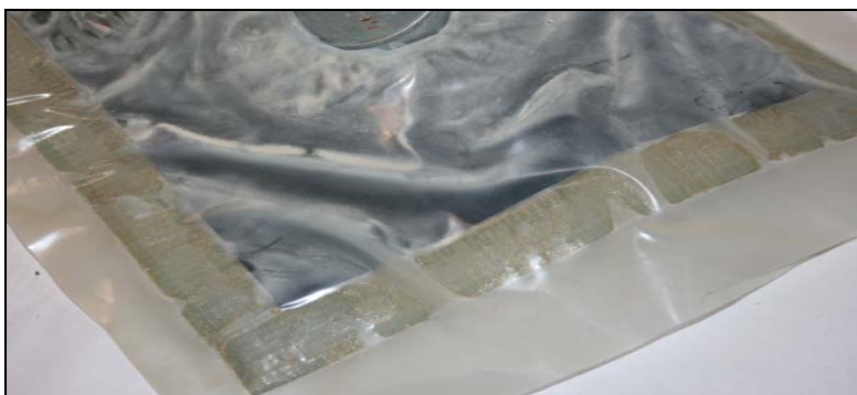
Figur 36. Exempel på hur folie och tejp har dragit ihop sig olika efter åldersprovning pga. olika dimensionsstabilitet.
